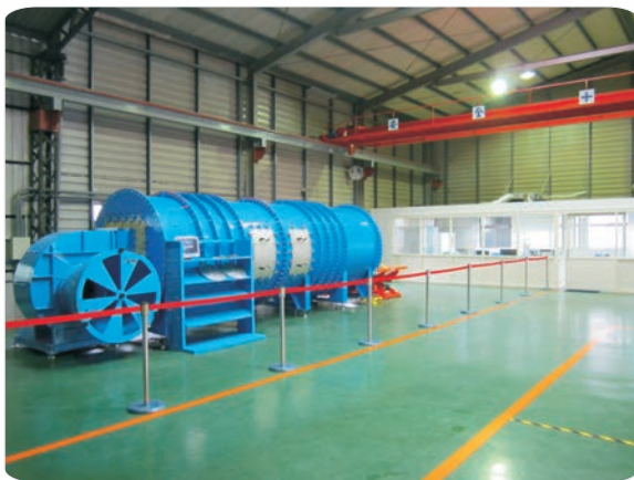
高壓風洞測試台
